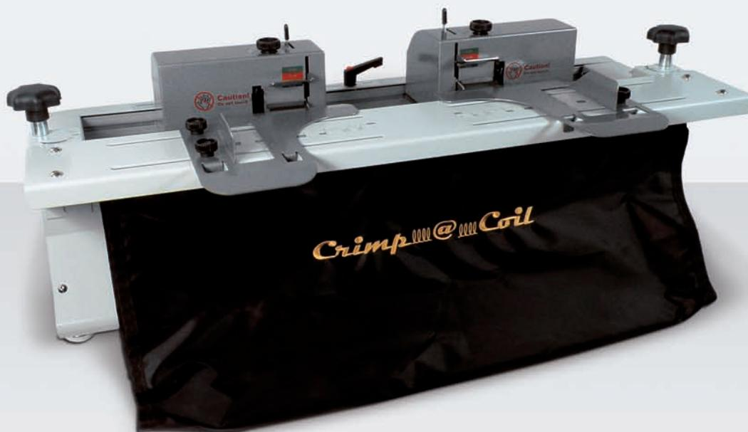
La Crimp@Coil es una máquina eléctrica de construcción robusta para el corte y doblado del espiral plástico en todos sus diámetros (de 8 a 50 mm) con un mismo cabezal. No requiere el uso de herramientas para los cambios de tamaño.
